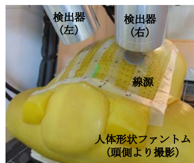
図 6.3.4-6 ^{241}\text{Am} 線源の測定風景
